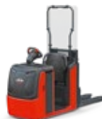
N20 - N25 C Preparador de pedidos de bajo nivel, con plataforma elevable Capacidad: 2,0 t - 2,5 t Variantes: B, HP
