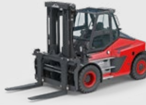
HT100 - HT180 Carretilla de gran tonelaje, transmisión hidrodinámica Capacidad: 10,0 t - 18,0 t
