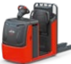
N20 C LX Preparador de pedidos de bajo nivel, con plataforma elevable Capacidad: 2,0 t
